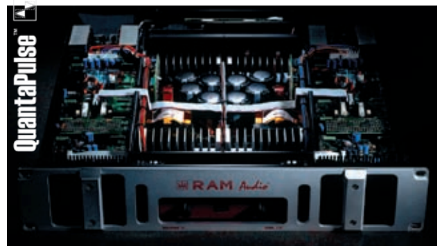
Das Schaltnetzteil: Kompakter Aufbau und geringes Gewicht.
