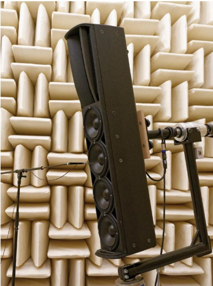
■ Nahfeldmessung direkt vor der Membran eines der vier Tieftöner
